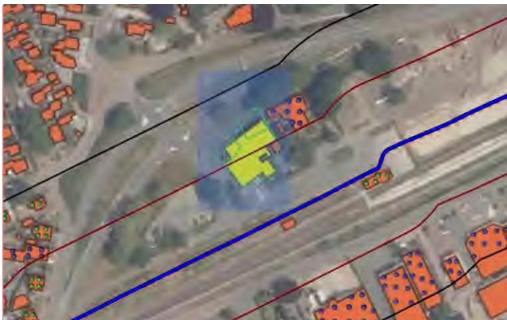
Figuur 2: Rekengebied buisleiding (donkerblauw). De zwarte lijn is de 1% letaliteitsgrens. De rode lijn de 100% letaliteitsgrens.
